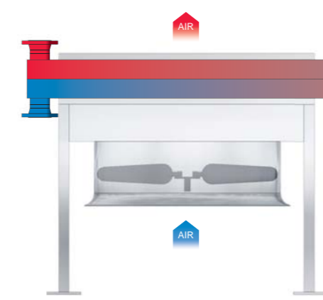
вентиляторы снизу, нагнетающие
